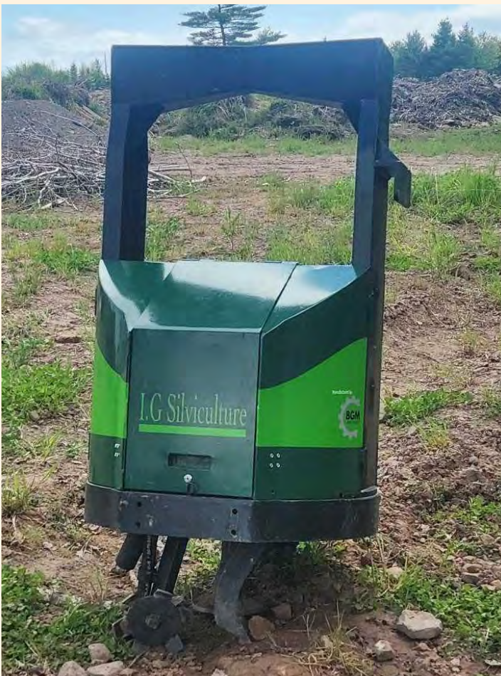
Le prototype de planteuse mécanique prêt à être fixé sur une récolteuse.
